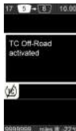
Диалоговое окно: противобуксовочная система для эксплуатации в условиях бездорожья включена
