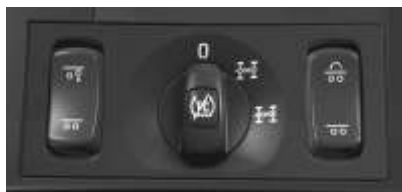
Регулирование тягового усилия: поворотный переключатель установлен в режим работы в условиях бездорожья
