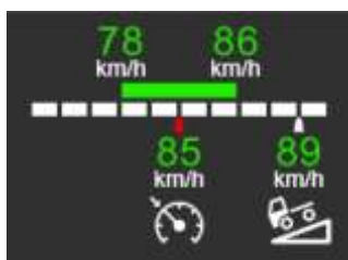
Крейсерская скорость и скорость спуска в нижней части, окно скорости – в верхней части
